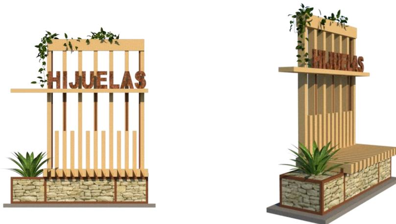
Construcción de Señaléticas de sectorización de la comuna de Hijuélas, donde se comprende la instalación de **19 letreros** a ejecutar en base a entramado de madera y muros gavión (materialidad con identidad local) emplazados en distintos lugares de la comuna. Su tamaño y forma permite la incorporación de jardineras en su altura, la instalación de letras metálicas con el nombre del sector y un muro que sirve de asiento para los pobladores.
